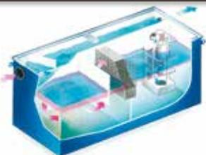
Ce système retient les produits polluants tels que les huiles et carburants qui peuvent se répandre accidentellement au sol, avant leur digestion vers le milieu naturel ou les égouts. Il ne s'agit pas d'un système de traitement des riges de l'atelier mais bien d'un dispositif servant à retenir les écoulements accidentels.
