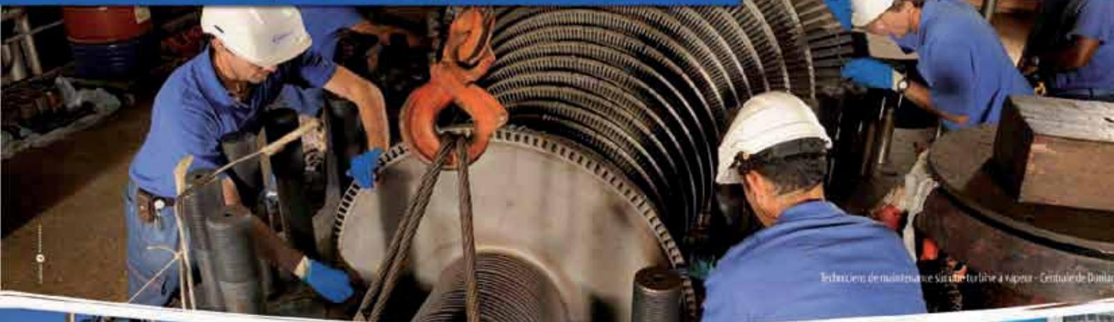
Techniciens de maintenance sur une turbine à vapeur - Centrale de Damblain
