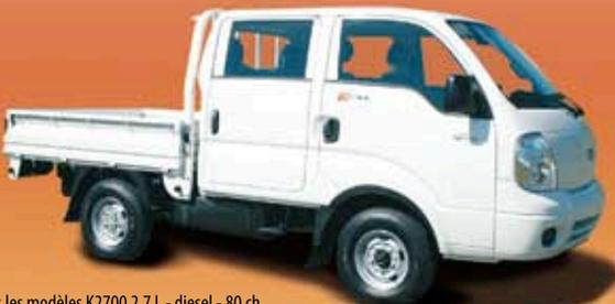
Tous les modèles K2700 2,7 L - diesel - 80 ch sont équipés d'une direction assistée, de vitres électriques, du verrouillage centralisé, d'un lecteur CD. La version 4x2 dispose en plus d'un pont arrière à glissement limité.
